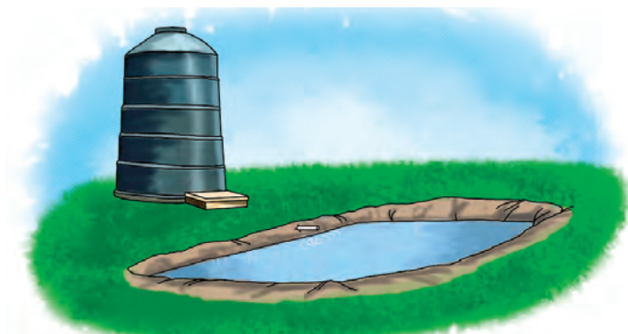
Biodigestor vertical e lagoa de recebimento do efluente (biofertilizante)
