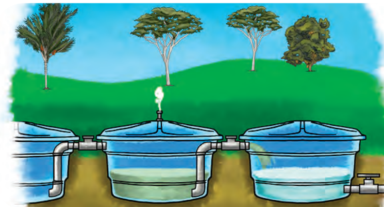
Deposição do efluente na 3ª caixa (coletora)
