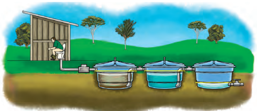
Esquema de instalação da fossa séptica biodigestora
