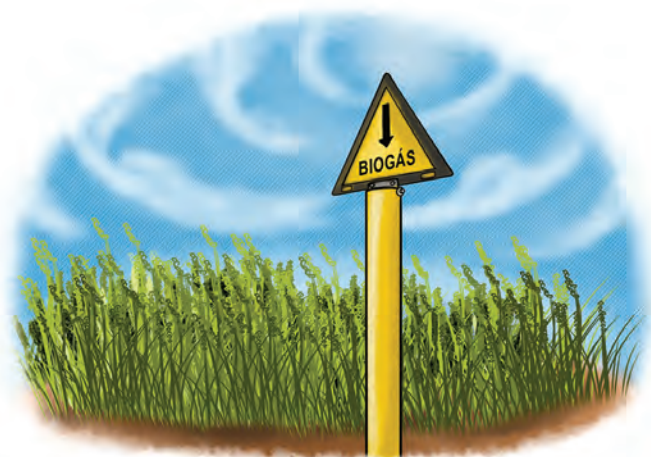
Sinalização da presença de gasoduto no subsolo
